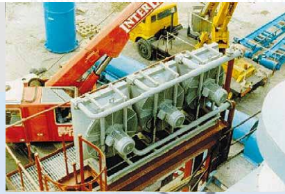
Cooling unit turbo-coupling, Voith
